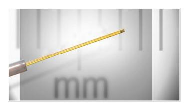
智能伸缩设计可在电缆操作和测试准备期间保护传感器头部。一旦准备好进行仪器测量,传感器头部就会暴露在被测物表面进行监测。传感器头部由一个小而坚固的聚酰亚胺管保护,传感器头部具有所需的刚度,可以轻松穿透硅胶,将传感器定位在模具或电路板的精确位置。
